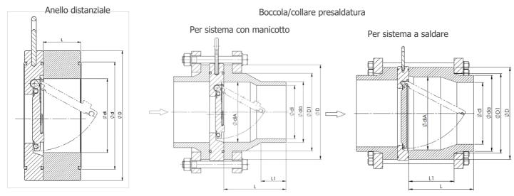
In caso di installazione tra flange con dimensioni di connessione conformi alla norma DIN EN 1092-1 B1 PN10, il diametro interno (di) deve essere mantenuto rispetto alla lunghezza (L) sul lato di uscita, al fine di garantire una corretta apertura del disco. Poiché il diametro interno delle linee di pressione in plastica è talvolta significativamente più piccolo del diametro nominale corrispondente alla connessione flangiata, sono necessari adeguati sistemi integrativi.
